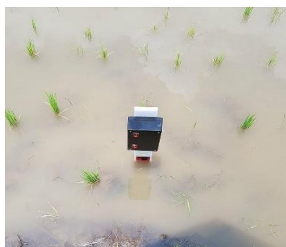
ภาพที่ 1.5 แสดงการติดตั้งอุปกรณ์วัดความชื้นที่แปลงทดลองจริง
