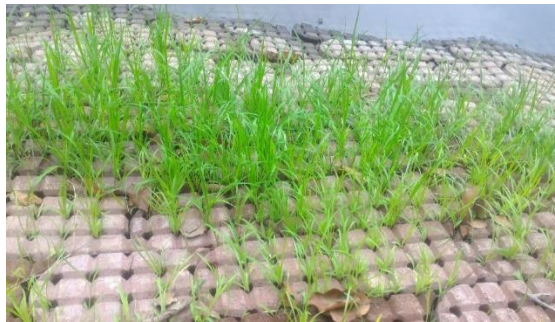
รูปที่ 9 การเจริญเติบโตของต้นพืชบนผลิตภัณฑ์สำหรับป้องกันการกัดเซาะตลิ่ง (ผลิตภัณฑ์จีโอเท็กซ์ไทล์จากยางธรรมชาติเชิงประกอบและผลิตภัณฑ์บล็อกประสาน) เมื่อเวลาผ่านไป 21 วัน
