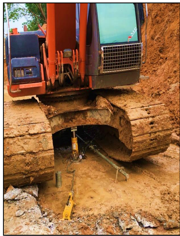
ภาพการตรวจสอบความแน่นของฐานราก ก่อน / หลังทำชอยซีเมนต์
