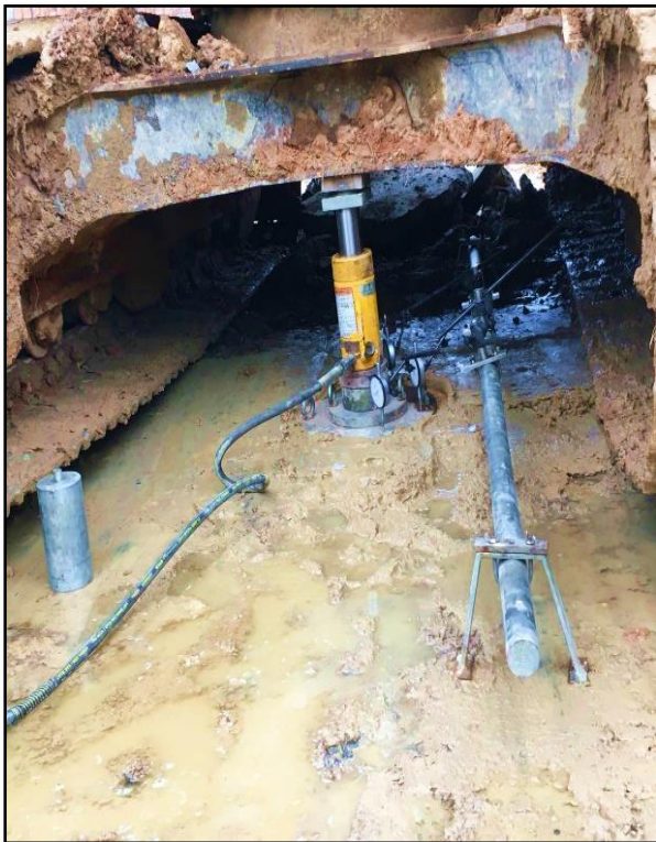
ภาพการตรวจสอบความแน่นของฐานราก ก่อน / หลังทำชอยซีเมนต์
