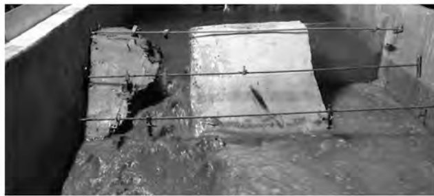
รูปที่ 14 การเคลื่อนตัวของค้นดินระหว่างค้นดินกับโครงสร้างประตุน้ำเมื่อน้ำไหลผ่านรอยต่อของกรณีที่ 3
