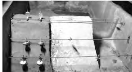
รูปที่ 7 ตัวอย่างคันดินที่ทำการบดอัดของกรณีที่ 3
