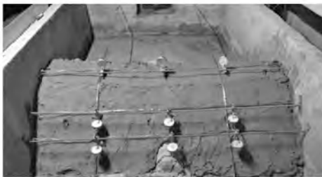
รูปที่ 6 ตัวอย่างคันดินที่ทำการบดอัดของกรณีที่ 2
